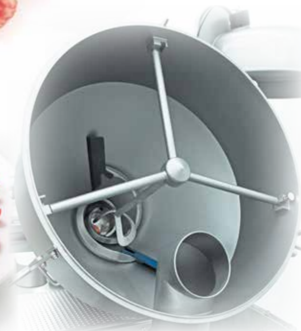
Tramoggia con doppio azionamento dell'agitatore, coclea di alimentazione e apertura di riempimento per il caricamento del sottovuoto.
